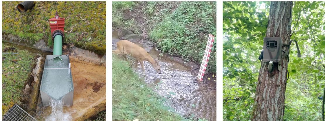
(a) Seuil triangulaire et sonde de pression en sortie de drain (b) Echelle limnimétrique dans le ruisseau des Magnelles (c) Appareil photo associé à l'échelle limnimétrique
