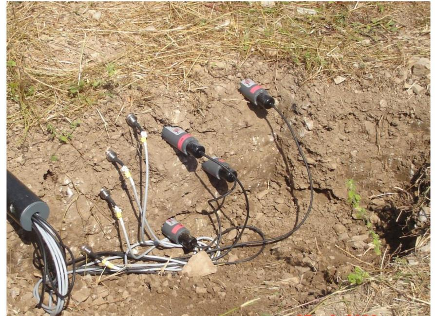
Installation des sondes de température et d’humidité du sol en 2009
