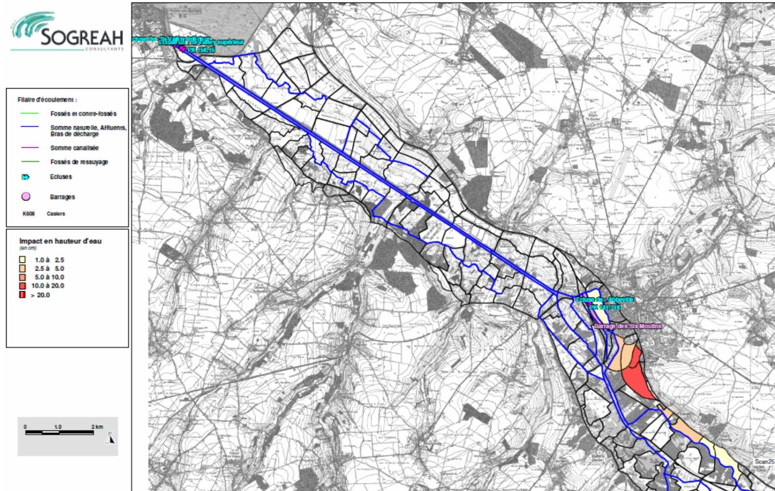
Figure 13 : Cartographie de l'impact en hauteur d'eau entre le scénario 2C et le scénario 2A.
