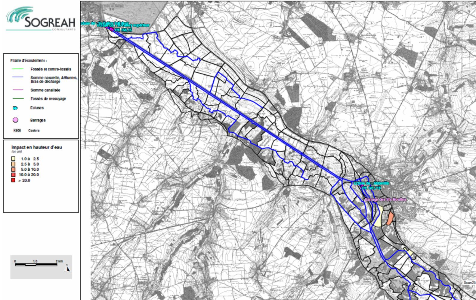
Figure 11 : Cartographie de l'impact en hauteur d'eau entre le scénario 2B et le scénario 2A.
